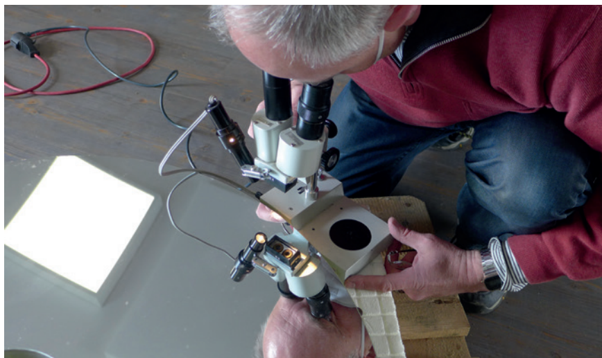
▲ Prüfung des restlichen Verschmutzungsgrads mit einem Aufsichtsmikroskop nach dem Waschen. Foto: Thomas Eversberg
