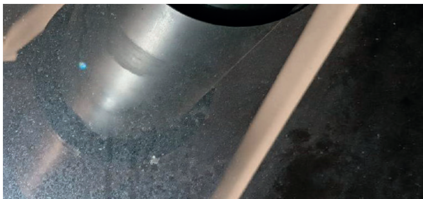
▲ Zustand nach der Dampfreinigung. Die rechte Spiegelhälfte ist signifikant sauberer als die unbehandelte linke Hälfte. Foto: Thomas Eversberg
