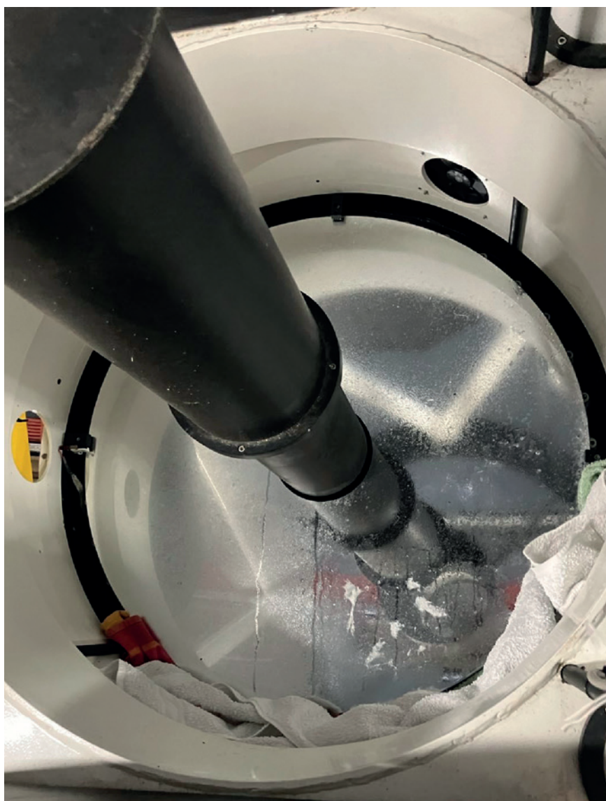
▲ Reinigung des 80-cm-Spiegels der Sternwarte Waldbröl mit Wasserdampf. Auf dem Spiegel sind noch feuchte Wattereste zu erkennen. Video der Reinigung siehe Kurzlinks. Foto: Thomas Eversberg
