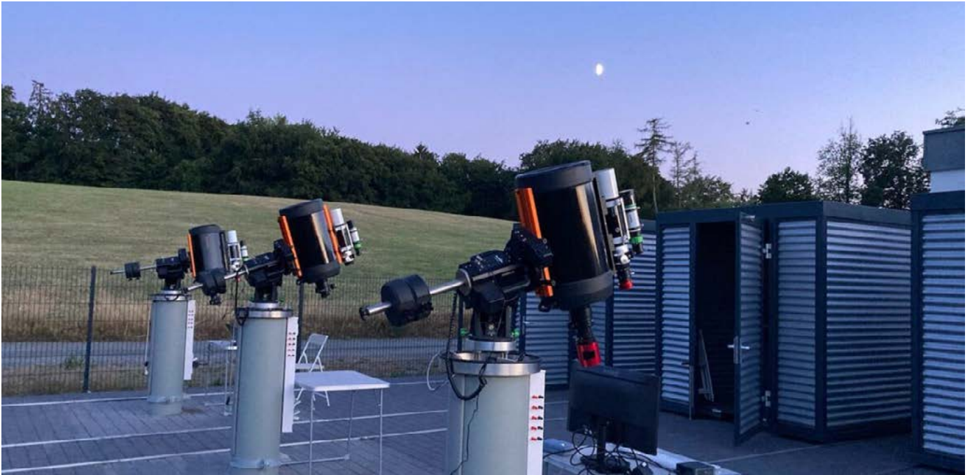
2 Das Schülerlabor mit drei identischen 28-cm-Teleskopen. Die wegschiebbaren ‚Würfel‘ aus Stahl können als beheizte Kontrollräume genutzt werden.
